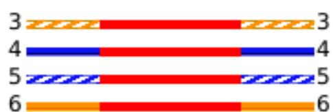
Dieses Kabel kann zu Ethernet-Datenfehlern führen und dadurch das Fehlschlagen des SignalTEK CT Datentests verursachen.
