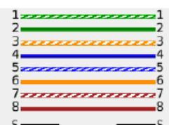
CAB0001 é um cabo de 4 pares 568B STP, de 52 metros de comprimento. Foi aprovado no teste de Mapa de Fios e de Dados e suporta 10Mb/s, 100Mb/s e 1Gb/s.
