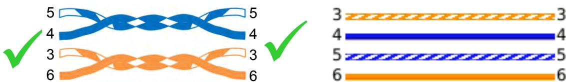
Si l'erreur est réparée à la mauvaise extrémité du câble, la continuité bout à bout est corrigée, mais un pairage mauvais est formé :
