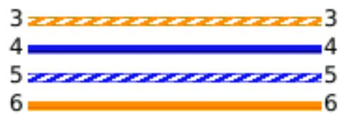
Se l'errore viene riparato all'estremità del cavo errata, la continuità end-to-end viene corretta, ma si forma una coppia spaccata:
