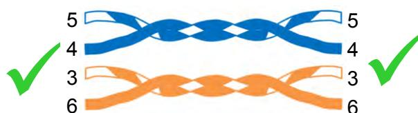
Si el error se repara en el lado del cable incorrecto, se corregirá la continuidad de principio a fin, pero se creará un par abierto:
