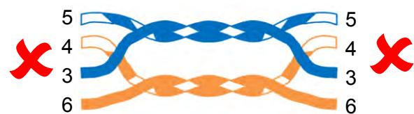
Este cable puede generar errores de datos de Ethernet y, en ese caso, el test de datos del SignalTEK CT fallará.
