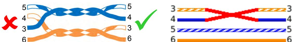
Si l'erreur est réparée à l'extrémité du câble où se trouve le défaut, le défaut est supprimé :
