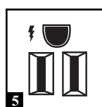
5 Prises protégées contre les surtensions
