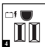
4 Prises protégées par batterie de secours ou protégées contre des surtensions transitoires
